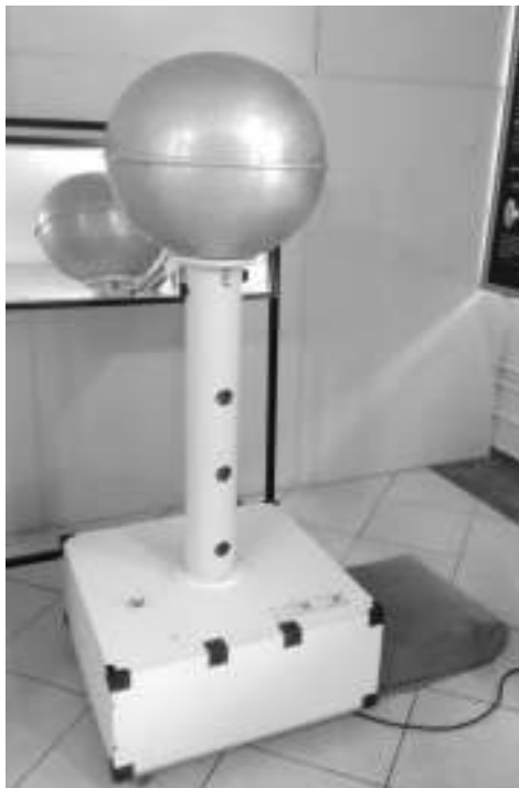
Imagem 2. O experimento do Gerador de Van Der Graaf é constituído de uma esfera metálica suspensa por um cano de plástico que, por dentro uma correia de borracha passa por duas polias isolantes, uma das polias está ligada a um motor. Quando ligado, o motor faz com que haja um atrito entre a polia e a correia, este atrito gera cargas elétricas que são coletadas por um pente de metal, posicionado próximo à polia superior, e está conectada à esfera metálica. Quando a pessoa se isola do chão e entra em contato com a esfera as cargas são transferidas a ela e tendem a ir para as extremidades do corpo como os cabelos, e como são cargas de mesmo sinal elas se repelem fazendo com que os cabelos se ergam.
