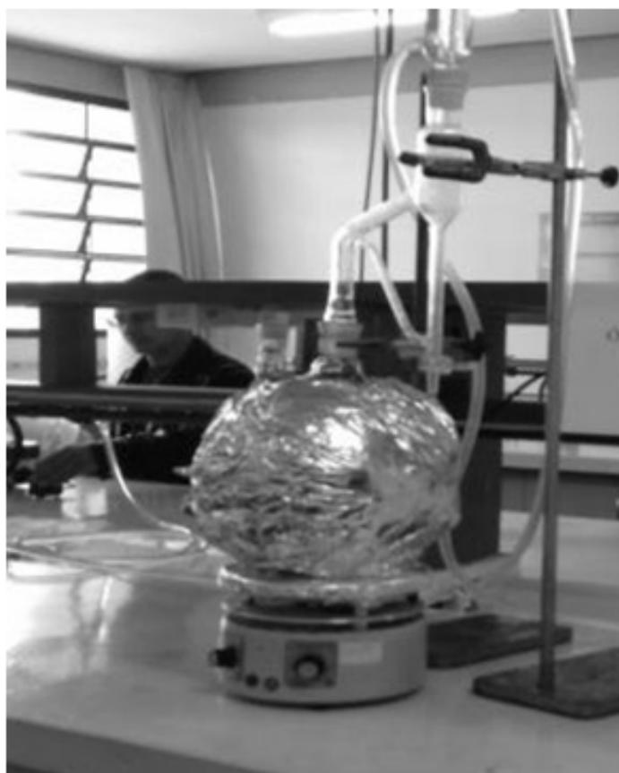
Figura 1. Sistema Clevenger utilizado para a extração do óleo essencial.
