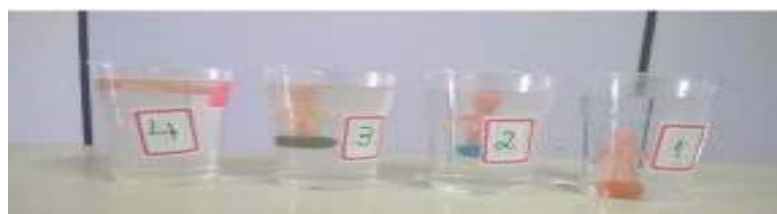
Figura 1. Ilustram as densidades das bonequinhas em diferentes condições de concentração de soluções salinas (2,3 e 4) e em água (1) a 27 C.
