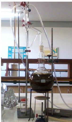
Figura 1 – Sistema de extração com o aparelho Clevenger.
